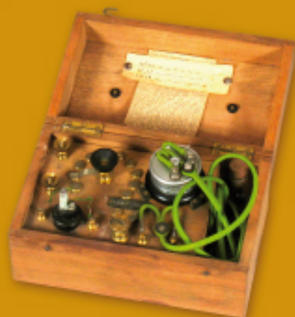
Récepteur F. Ducretet et E. Roger à détecteur électrolytique, France, vers 1911
